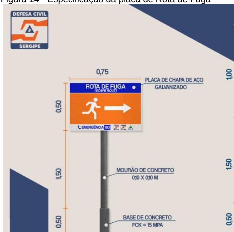
Figura 14 - Especificação da placa de Rota de Fuga
